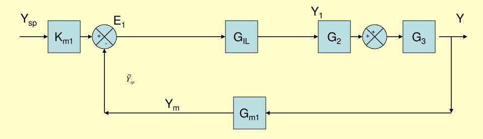
$$\frac{Y}{Y_{sp}} = \frac{K_{m1}G_{IL}G_2G_3}{1 + G_{m1}G_{IL}G_2G_3}$$
